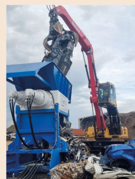
Triturazione e riduzione di veicoli a fine vita pronti per il riciclo
